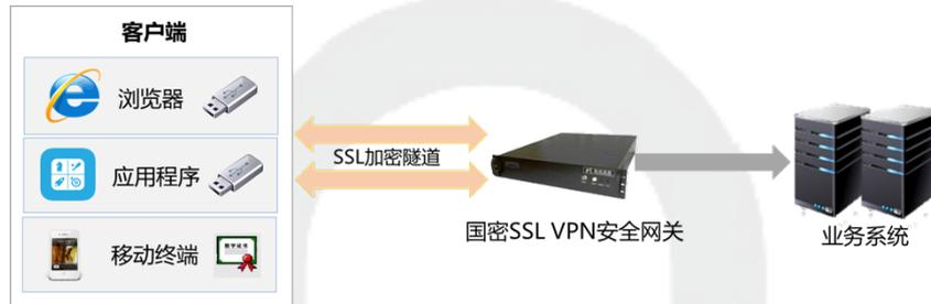
图 5-3 SSL VPN 安全网关部署示意图
